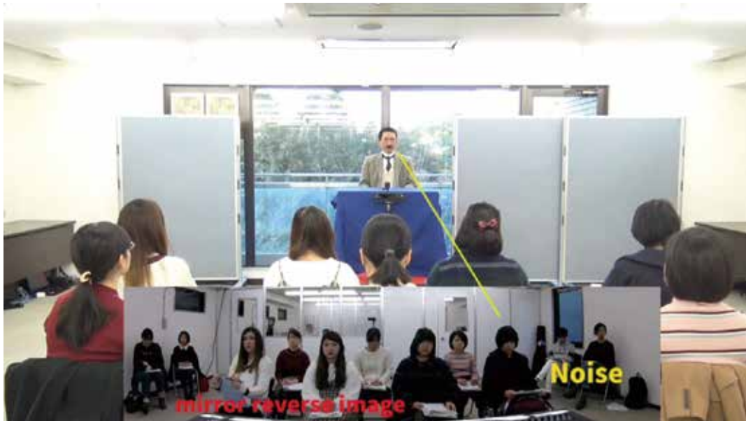
図2: 実験の様子。図中下部がセンサに入力されている画像。図中右の実験参加者がノイズを出した際に漱石アンドロイドがそちらを向いている状況。
